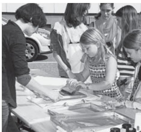
Mit der Rakel die Farbe auf dem Sieb verteilen, so wird die Tasche bedruckt.
